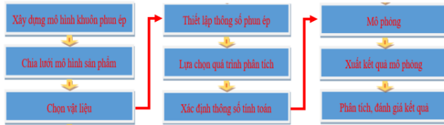
Hình 3.21: Trình tự mô phỏng gia nhiệt khuôn bằng khí nóng
